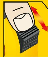
Contrôlez le taux du rembobinage et assurez-vous que la lame ne plie pas pour éviter une action non-contrôlée
