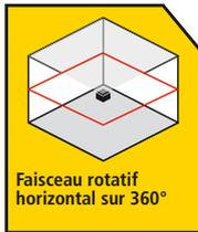
Faisceau rotatif horizontal sur 360°
